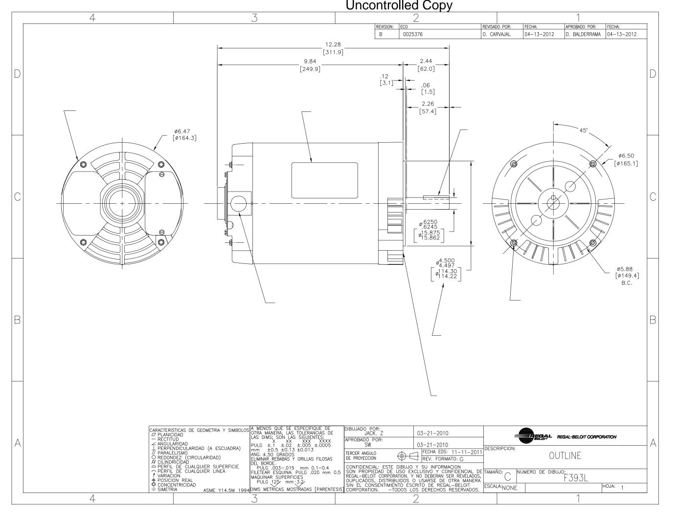
Uncontrolled Copy 4 0025376 O. CARVAJAL 04-13-2012 D. BALDERRAMA 04-13-2012 12.28 [311.9] 9.84 2.44 [249.9] [62.0] .12 [3.1] .06 [1.5] 2.26 \_ [57.4] ø6.47 [ø164.3] ø6.50 \_ [ø165.1] \_ <sup>ø.</sup>6250 \_ <sup>ø.</sup>6245 \_ ø15.875 15.862 ø4.500 4.497 [ø114.30 114.22] ø5.88 [ø149.4] B.C. JACK. Z 03-21-2010 REGAL REGAL-BELOIT CORPORATION SW OUTLINE 第三角投影 机密:本图纸及相关信息所有权归REGAL-BELOIT CORPORATION。 未经REGAL-BELOIT CORPORATION书面授权,不得泄露、 F393L 复制、传播或作其他用途。—版权所有 NONE ASME Y14.5M 1994 米制尺寸显示在[] 4
